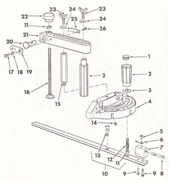
FIGURE 4 — 62704 & 62776 MITER GAUGE ASSEMBLY
