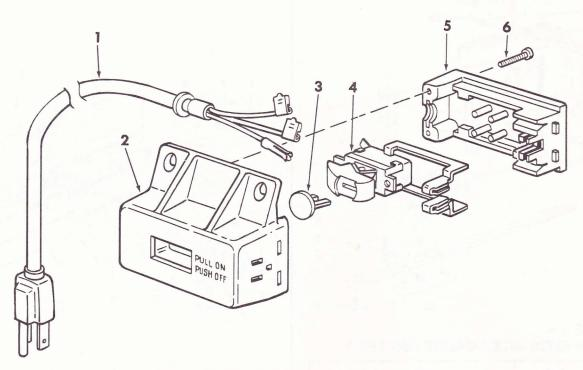
FIGURE 6 - ON/OFF POWER OUTLET 60381
